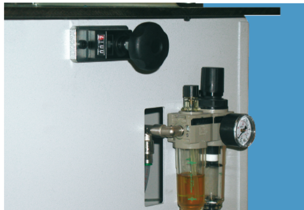
REGOLAZIONE BATTUTA ORIZZONTALE CON VISORE ADJUSTMENT OF HORIZONTAL STOP WITH READOUT EINSTELLUNG WAAGRECHTER ANSCHLAG MIT SICHTGERÄT RÉGLAGE BUTÉE HORIZONTALE AVEC VISEUR REGULACIÓN TOPE HORIZONTAL CON VISOR
